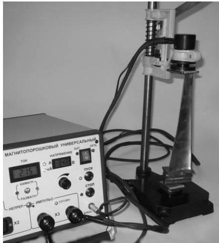
Рисунок А.4.1 Циркулярное намагничивание лопаток. Длина лопатки 290 мм. Ток 2150А
